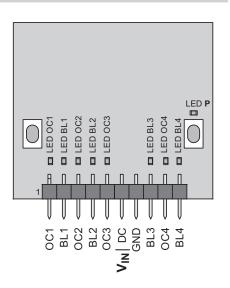
**RCD21E5004A01** 3.0 V - 8.0 V **RCD21E5004A02** 8.0 V - 36.0 V
